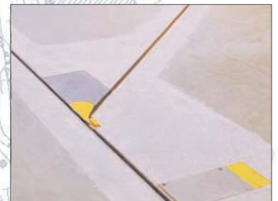
Wissel met RFID-sensor
