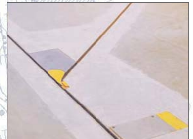
Weiche mit RFID-Sensor
